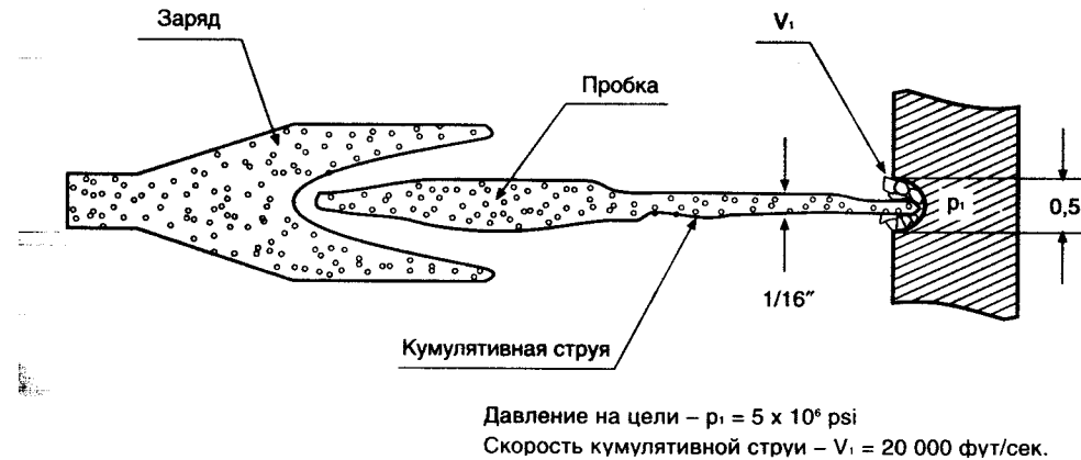
Рис. 3.2б. Приблизительные скорость и давление в кумулятивной струе
